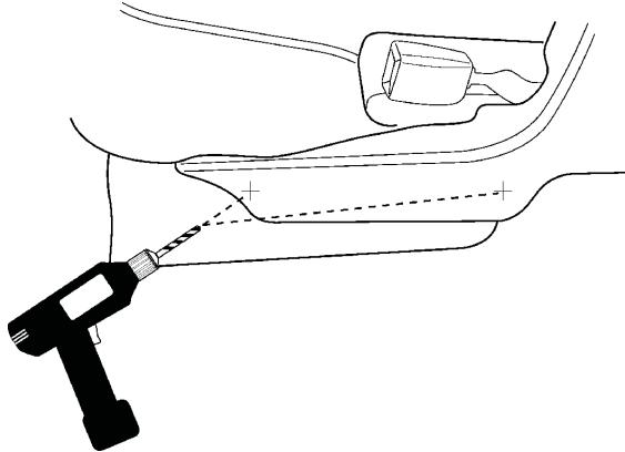
2. Con el asiento en posición vertical y con una broca de 1/8" y un tope de broca de 1/4" perfore cuidadosamente las áreas marcadas en los paneles plásticos laterales del asiento. Asegúrese de no perforar más de 1/4" de profundidad en los paneles plásticos laterales del asiento. A continuación agrande los agujeros piloto con una broca de 5/16" y un tope de broca de 1/4". Aspire las astillas de plástico cuando termine.
