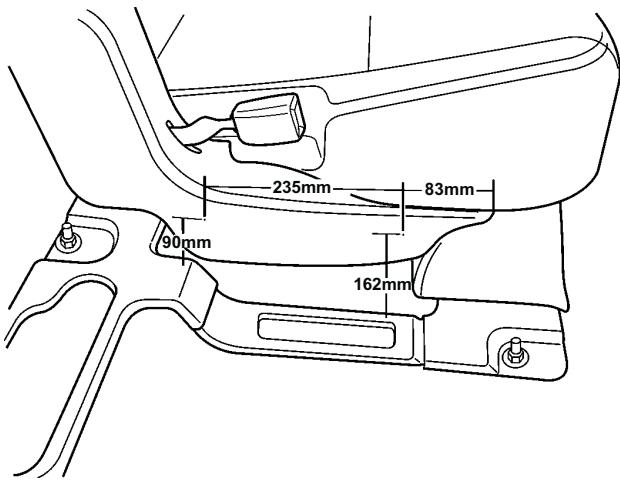
1. Con el asiento en posición vertical, mida y marque el panel plástico del asiento del lado derecho del asiento de segunda fila del lado del conductor en las siguientes ubicaciones para perforar. Repita el paso para el panel plástico del asiento del lado izquierdo del asiento de segunda fila del lado del pasajero.
