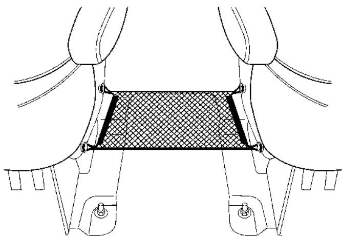
4. Con el asiento en posición vertical, la instalación terminada del ensamble de red debe verse así. Tenga cuidado de desenganchar el ensamble de red antes de doblar y voltear el asiento.
