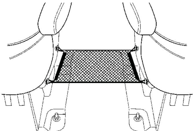
4. L'installation achevée du filet d'arrimage devrait ressembler à ceci tandis que le siège est en position verticale. Prière de détacher le filet d'arrimage pour replier le siège.
