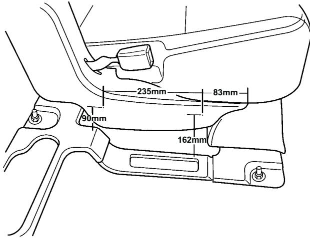
1. Tandis que le siège est en position verticale, mesurer et marquer aux emplacements suivants, aux fins de perçage, le panneau de siège en plastique de droite du siège de 2<sup>e</sup> rangée sur le côté conducteur. Reprendre l'étape sur le panneau de siège en plastique de gauche du siège de 2<sup>e</sup> rangée sur le côté passager.
