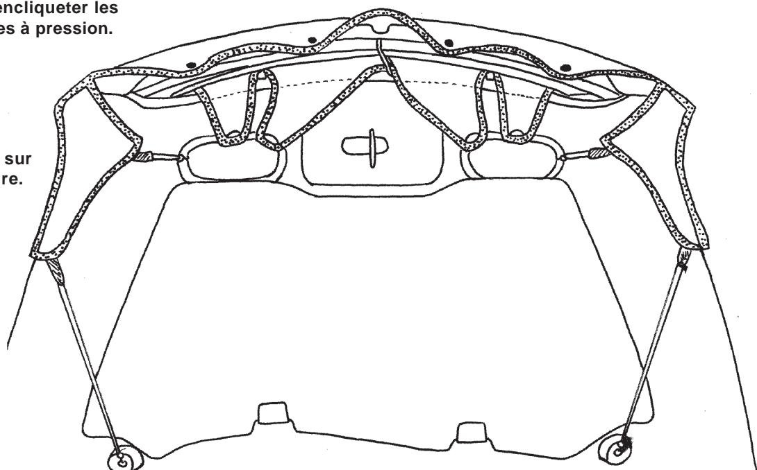
**Fixer le crochet en «S» sur le rebord de la structure.**
