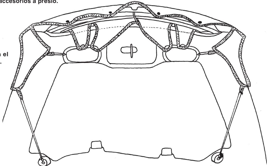
**Instale el gancho "S" en el borde de la estructura.**
