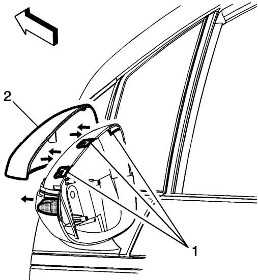
11. Soulever et glisser droit devant le couvercle de boîtier (2) pour dégager les pièces de fixation (1) du boîtier.
