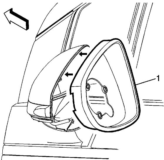
1. Poser le nouvel enjoliveur de boîtier (1) sur le boîtier de rétroviseur en s'assurant que les pièces de fixation sont entièrement engagées.
