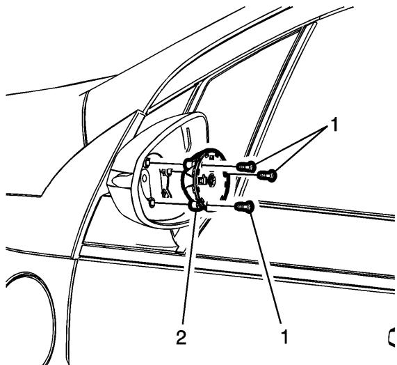
7. Retire los tornillos del actuador interno del espejo retrovisor exterior (1). Conserve los tornillos para volver a ensamblar.
