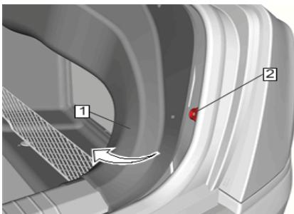
3. Inserte la tuerca J alrededor del soporte de metal expuesto como se muestra en la Figura 3.
