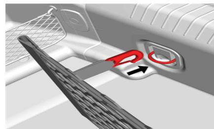
7. Sujete los aros superiores de la red de conveniencia alrededor de los retenedores en forma de T como se muestra en la Figura 6 (ambos lados del vehículo).
