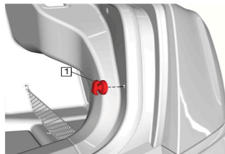
6. Sujete los ganchos inferiores de la red de conveniencia a los aros de amarre de carga como se muestra en la Figura 5 (ambos lados del vehículo).
