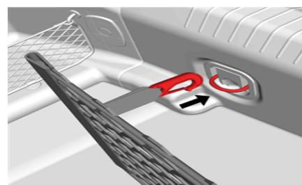
7. Fixer les boucles supérieures du filet à bagages autour des dispositifs de retenue en T, comme illustré à la figure 6 (des deux côtés du véhicule).
