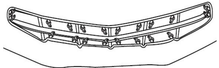
6. Enganchez les crochets situés sur la partie inférieure du pare-chocs à la face inférieure du véhicule.
