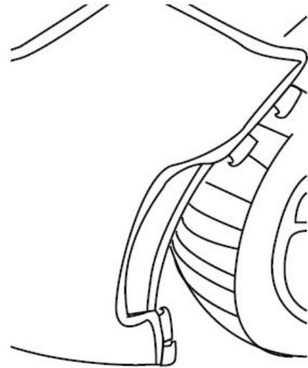
5. Attacher les crochets sur le bord de l'ouverture de la grille.
