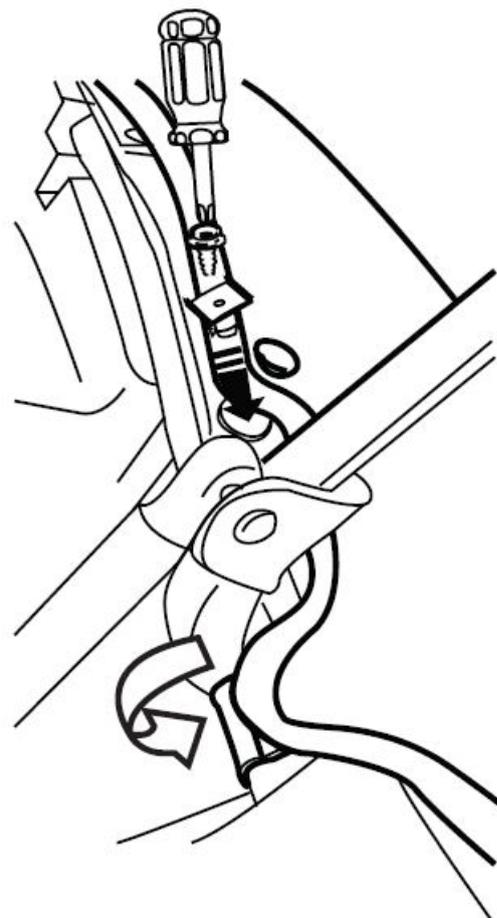
3. Insérez les tampons dans l'espace au milieu du phare et devant le véhicule. Réalisez le même pas de l'autre côté.
