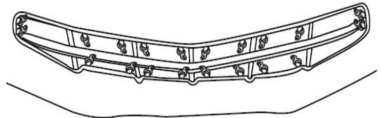
6. Attacher les crochets situés sur la face inférieure du masque sur la face inférieure du véhicule.
