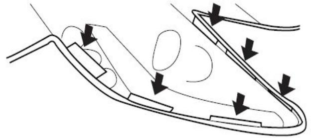
4. Enganchez les crochets sur les bords du véhicule. Réalisez le même pas de l'autre côté.
