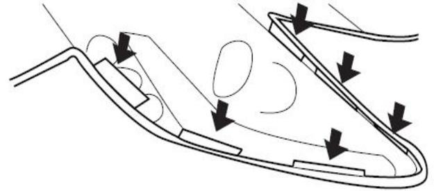
4. Attacher les crochets sur le bord du passage de roue.
