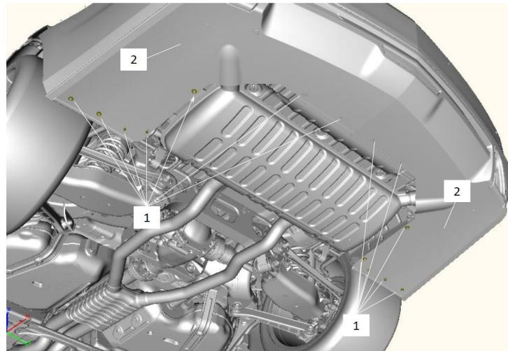
1. En commençant à l'arrière du véhicule, déposer les 14 boulons (1) du carénage inférieur (2). Le carénage inférieur ne peut pas être complètement déposé mais il se fléchit suffisamment pour permettre la dépose de l'échappement d'usine.
