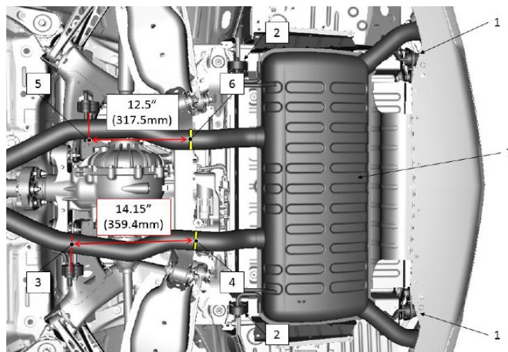
2. Les tuyaux d'échappement côté conducteur et passager passent sous le sous-cadre, tout juste derrière le différentiel. Faire une marque au centre du tuyau d'échappement du côté passager à l'endroit où il croise le bord arrière de l'étrier (3) et faire une autre marque à 14,15 po de l'arrière du véhicule afin d'identifier le centre de la ligne de découpe (4), comme indiqué sur l'illustration ci-dessus. Marquer la ligne de découpe à la perpendiculaire du tuyau.
