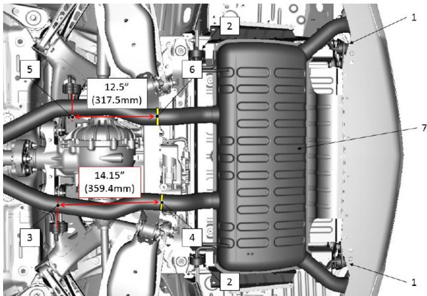
2. Los tubos de escape del lado del pasajero y conductor pasan debajo del sub-marco justo detrás del diferencial. Marque el centro del tubo de escape del lado del pasajero donde se cruza con el borde trasero del colgador (3) y realice otra marca a 14.15" a la parte trasera del vehículo para identificar el centro de la línea de corte (4) como se muestra en la imagen anterior. Marque la línea de corte de forma que sea perpendicular al tubo.
