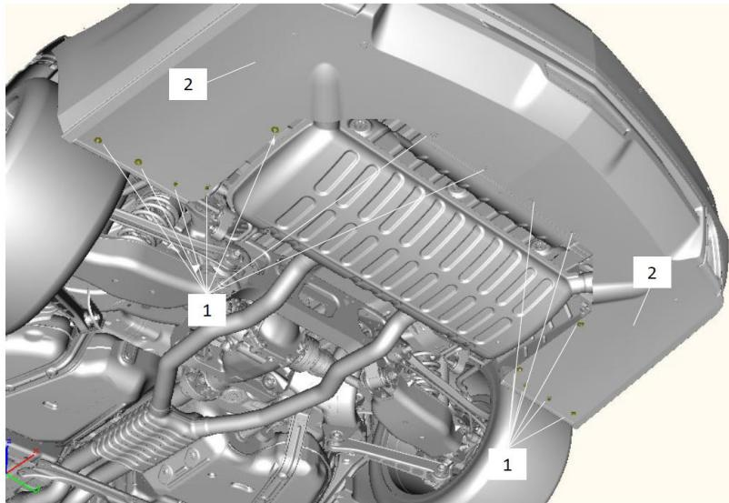
1. Comenzando en la parte trasera del vehículo, retire los 14 pernos (1) de la facia inferior (2). La facia inferior no se puede retirar completamente pero se flexionará lo suficiente para permitir la desinstalación del escape de fábrica.
