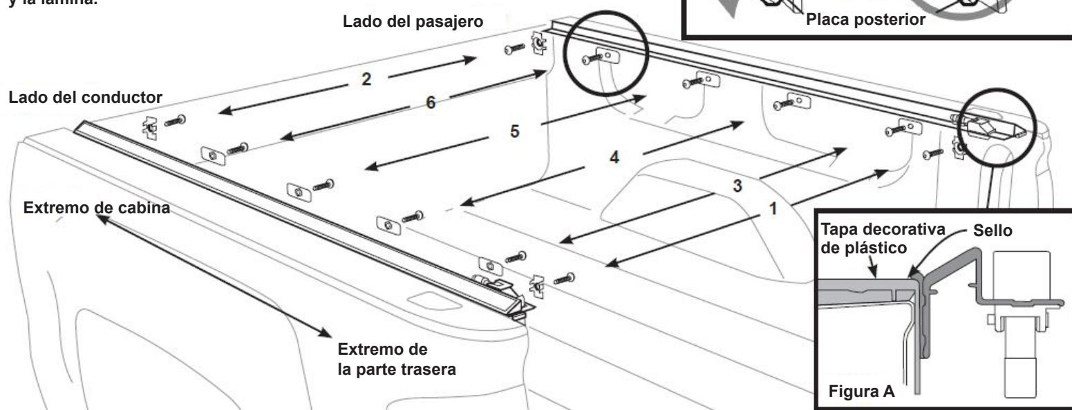
**Instalación de cubierta:**
