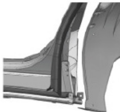
Rear, remove Air deflector and wheel house lining Arrière, déposer le déflecteur d'air et la garniture de passage de roue Trasero, retire el deflector de aire y el revestimiento del alojamiento de la rueda
