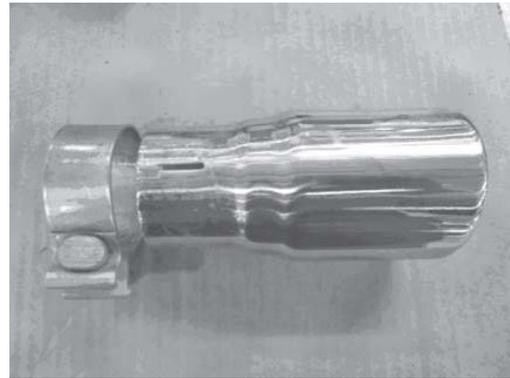
6. Coloque el ensamble de la punta del escape sobre el tubo del escape cortado y alíneelo con la segunda marca medida en el escape.
