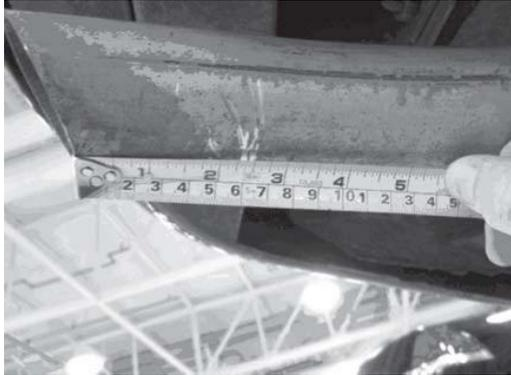
3. Usando una sierra caladora o una sierra para metales corte el tubo del escape en ángulo recto en la marca de 2.25 (6.0 cm).
