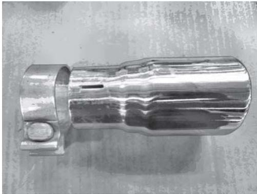
3. Coloque el ensamble de la punta del escape sobre el tubo del escape y alíneelo con la marca medida en el escape.
