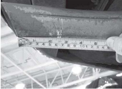
3. Utiliser une scie à métaux ou une scie alternative pour couper le tuyau d'échappement à angle droit, au repère de 2,25 pouces (6,0 cm).
