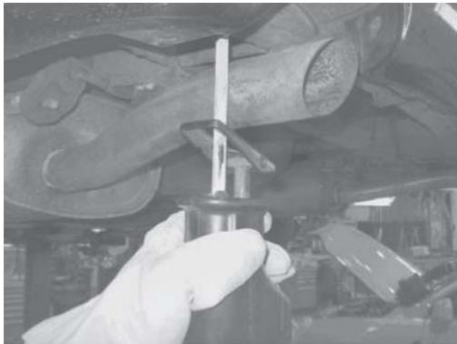
5. Placer le collier de l'embout d'échappement sur l'embout, l'écrou étant orienté vers le bas.
