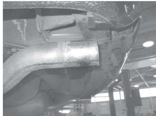
7. Coloque la punta del escape de manera que el orificio de drenaje quede hacia abajo.
