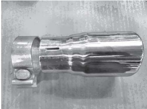
3. Placer l'ensemble d'embout d'échappement sur le tuyau d'échappement d'origine, en l'alignant sur le repère de mesure de l'échappement.
