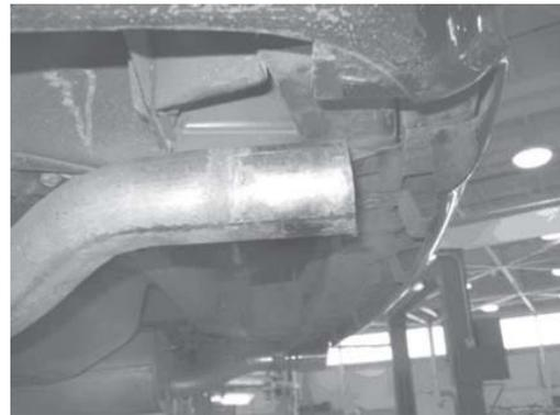
7. Aligner l'embout d'échappement de telle manière que l'orifice de sortie soit orienté vers le bas.
