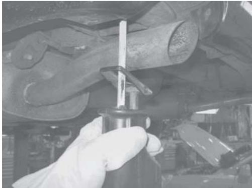
5. Coloque el sujetador de la punta del escape sobre la punta del escape con la tuerca hacia abajo.
