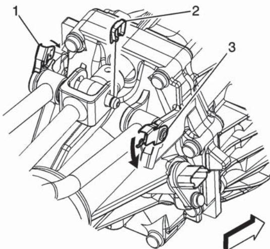
Con una herramienta de punta plana, libere el retenedor del pasador de la varilla de control de cambios central (2). (vea anteriormente).
