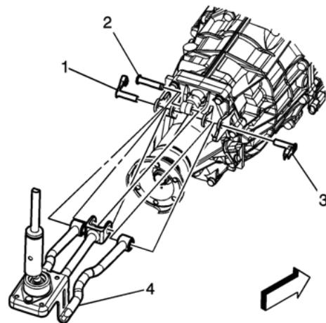
Soulever la boîte de vitesses pour la remettre en place et positionner en même temps le levier de vitesses dans le plancher au bon emplacement. Reposer les boulons fixant la traverse de boîte de vitesses à la carrosserie et les serrer à 58 Nm (43 lb-pi).
