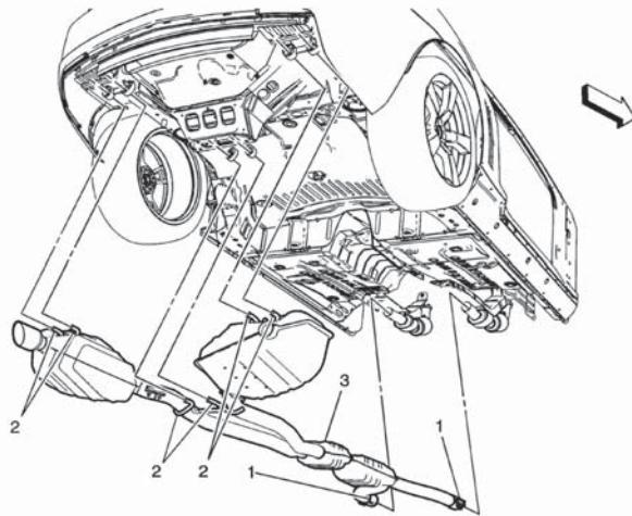
Déposer le bouclier thermique de système d'échappement pour accéder à l'ensemble palier central d'arbre d'entraînement.
