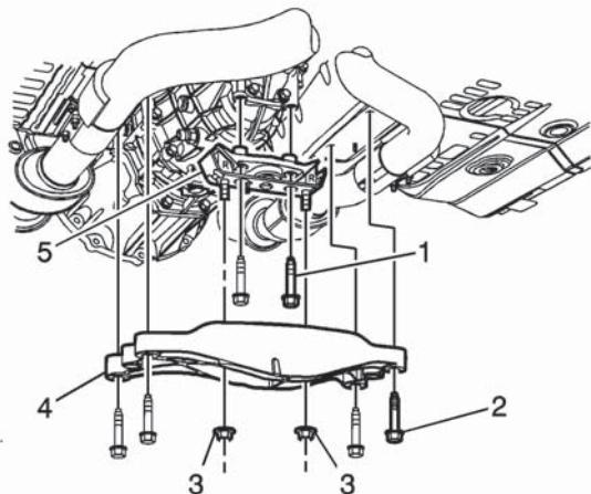
Baje la transmisión para tener acceso al ensamble de la palanca de cambios en la parte superior de la transmisión.
