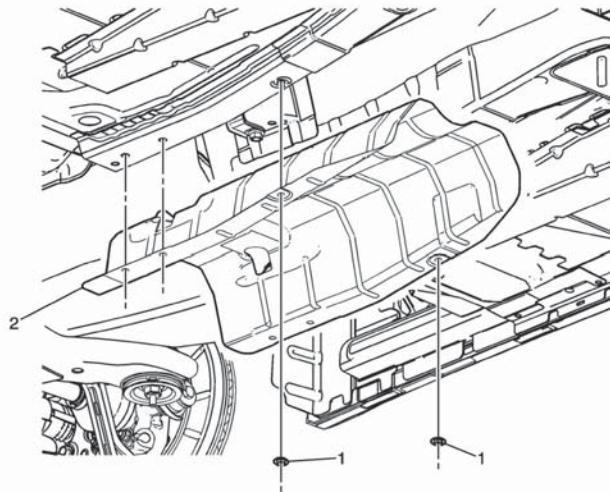
Retire los pernos de soporte del centro del eje de transmisión (2) y baje el centro del eje de transmisión.
