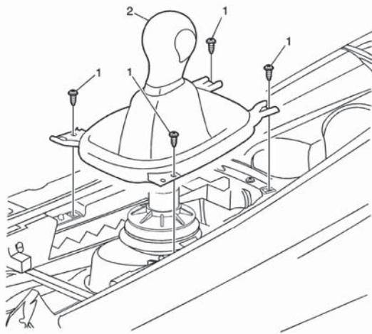
Déposer ensuite les 4 fixations retenant l'ensemble levier de vitesses au plancher au moyen d'une douille 10 mm.
