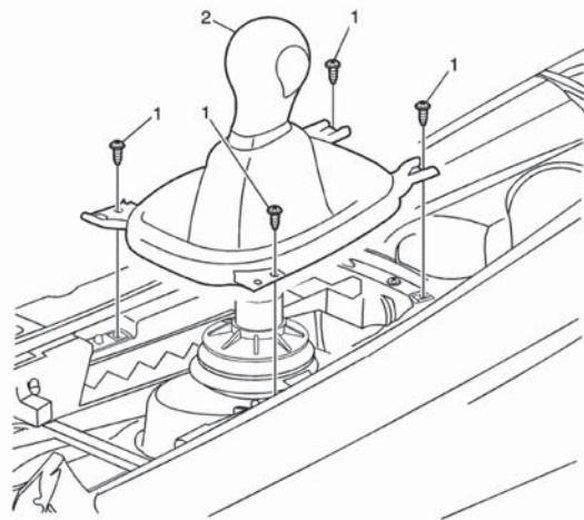
A continuación retire los 4 sujetadores que sostienen el ensamble de la palanca de cambios al piso utilizando un casquillo de 10mm.
