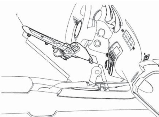
Retire la perilla de la palanca de control de transmisión y en ensamble de funda como se muestra a continuación.
