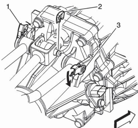
Utiliser un outil à lame plate pour dégager le dispositif de retenue de la goupille de tige de commande de changement de vitesse central (2). (Voir ci-dessus).
