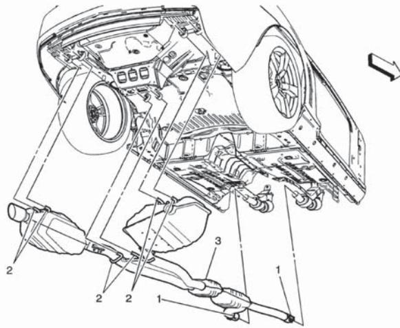
Retire la protección térmica del escape para tener acceso al ensamble del cojinete central del eje de transmisión.
