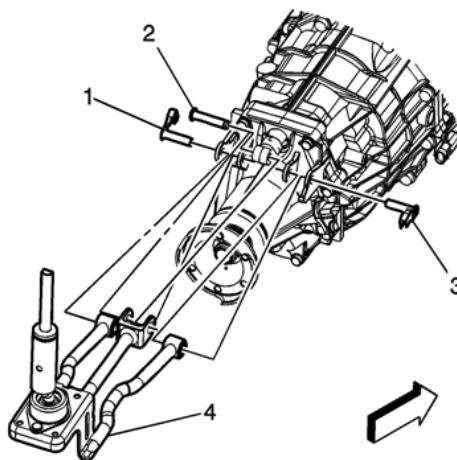
Levante el ensamble de la transmisión de nuevo en su posición y al mismo tiempo coloque la palanca de cambios en el piso en la ubicación adecuada. Vuelva a instalar el miembro transversal de la transmisión a los pernos de la carrocería y apriete a 58 nm (43 lbs-pie).
