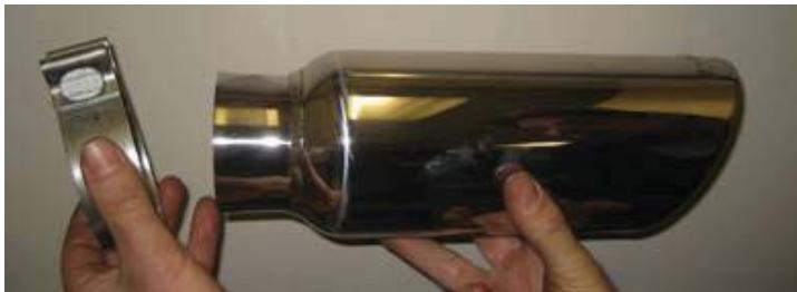
2. Mesurer à partir de l'extrémité extérieure du tuyau d'échappement (côté inférieur) une distance de 8 pouces vers l'intérieur le long de l'axe du tuyau. Tracer une marque à la distance de 8 pouces. Nettoyer l'extrémité du tuyau pour assurer un bon ajustement serré.
