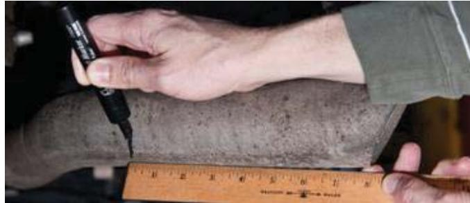
3. Instale la punta sobre el extremo del tubo. Deslice la punta hacia arriba de tubo hasta que el borde llegue a la marca. Verifique que su sistema de escape tenga el espacio adecuado debajo del vehículo y también para la alineación de la punta.
