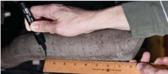
3. Instale la punta sobre el extremo del tubo. Deslice la punta hacia arriba de tubo hasta que el borde llegue a la marca. Verifique que su sistema de escape tenga el espacio adecuado debajo del vehículo y también para la alineación de la punta.
