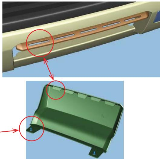
3. Asegure el soporte de conexión a la facia usando los 6 remaches.
