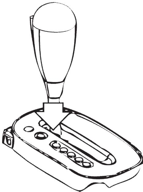
3. Afloje el tornillo de ajuste y jale la perilla de cambios hacia arriba (hacia el techo del vehículo).
