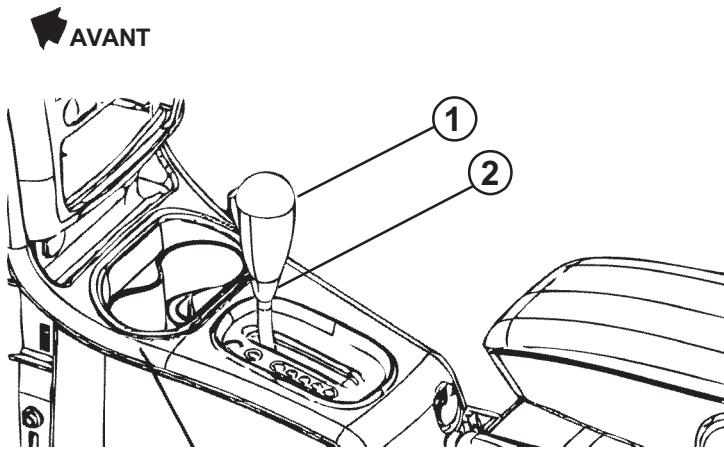
2. Régler le sélecteur de vitesses au point mort, puis engager le frein de stationnement. Tirer la gaine ou le manchon du levier de vitesse vers le bas pour exposer la vis de fixation.
