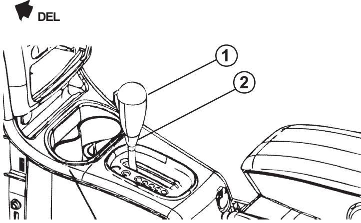
2. Coloque la palanca de cambios en neutro y active el freno de estacionamiento. Jale la cubierta o la manga de cambios hacia abajo para mostrar el tornillo de fijación.
