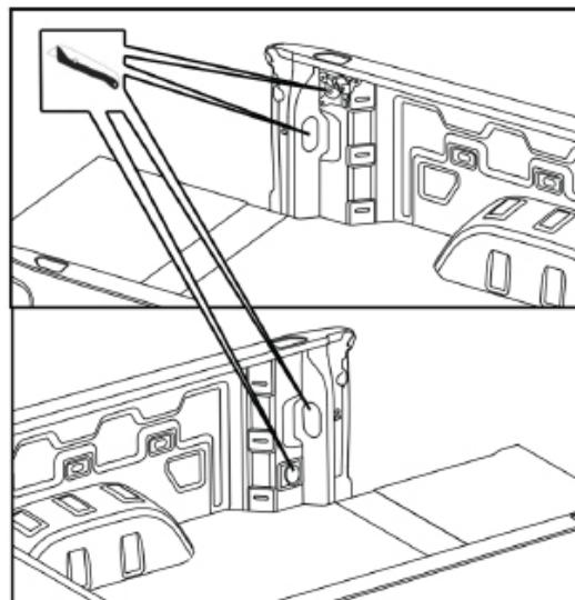
Si la cama de su camioneta cuenta con la opción de luces de carga, tomacorriente de 110/230 V o manija auxiliar, recorte la sección utilizando las líneas de corte en la parte trasera de las paredes laterales.
