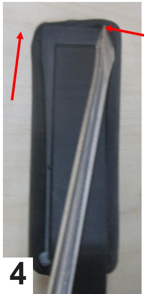
3. Faire tourner la pédale et utiliser un tournevis à lame plate pour engager les bords du coussin.
