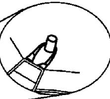
Accrocher la courroie par-dessus la butée du capot.
