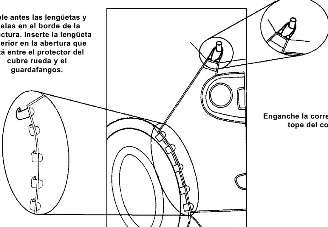
6. Instale todos los puntos de afianzamiento de la manera que se indica en la ilustración.
