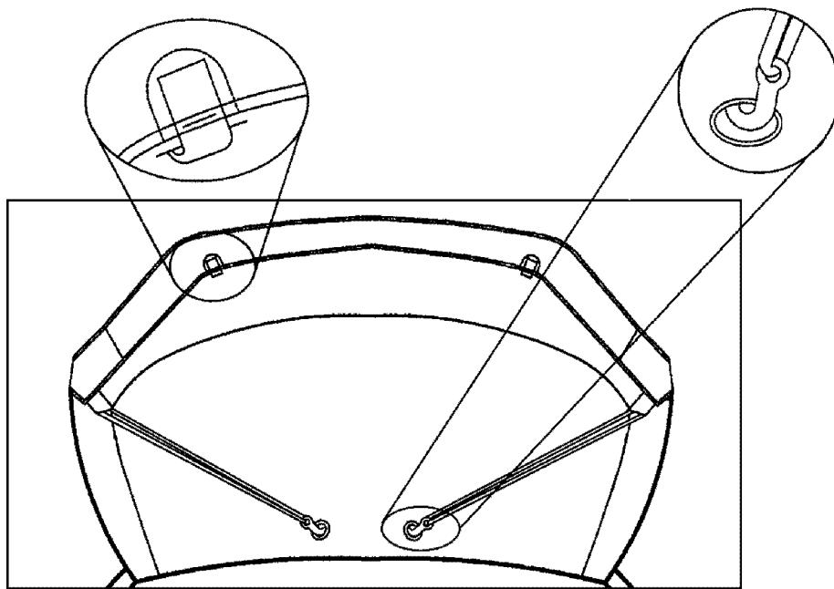
3. Coloque la parte inferior de la cubierta del extremo delantero sobre los guardafangos y en la rejilla de su vehículo. Si va a utilizar una matrícula delantera, corte las rosas negras en la parte trasera del parche de la matrícula. Deslice el soporte de la matrícula del vehículo a través de esta abertura. Una vez el soporte se introduce, dé forma a la cubierta del extremo delantero alrededor de la defensa un lado a la vez.
