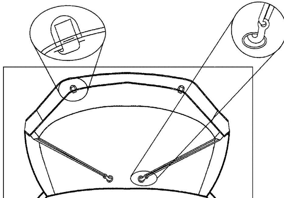
3. Placer la partie inférieure du protège-calandre par-dessus les ailes et la calandre du véhicule. Si l'on prévoit utiliser une plaque d'immatriculation avant, couper les fils noirs à l'endos de la pièce pour plaque d'immatriculation. Faire glisser le support de la plaque d'immatriculation du véhicule dans cette ouverture. Une fois que le support aura été acheminé, former le protège-calandre autour du pare-chocs, un côté à la fois.
