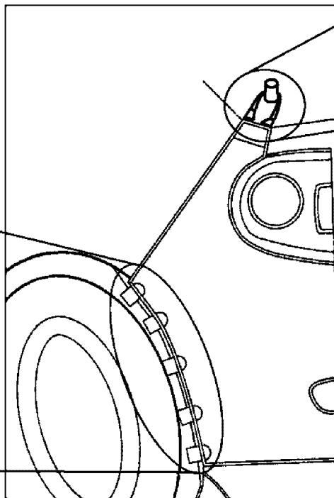
Fixer le crochet en «S» sur le rebord de la structure.
