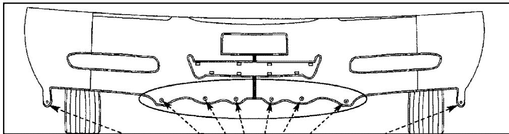
Retire los accesorios existentes. Inserte tornillos (SS No. 1) en los agujeros y apriete. Luego, cierre los accesorios a presión.
